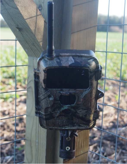
Figur 3: Vildtkameraer blev med stor succes anvendt til overvågning af fangburene. Det var på denne måde let at danne sig et overblik over hvilke fangbure som blev benyttet regelmæssigt og hvornår fuglene var gået i fælden. Foto: Lene Midtgaard
