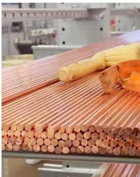
De her kobberstænger bliver efter nogle få sekunder i en CNC-maskine til Sako Powerhead Blade-projektiler.
