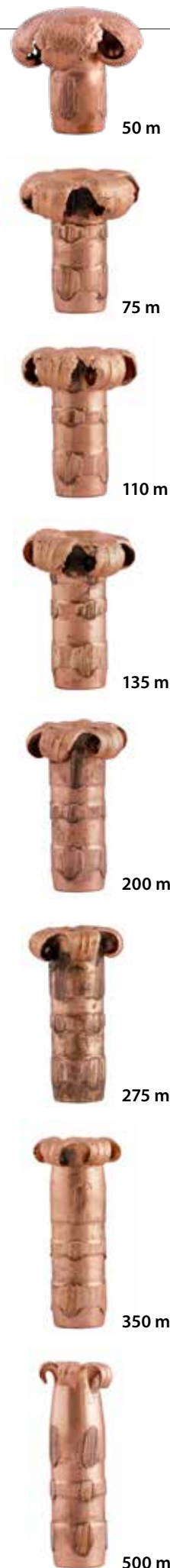
Her ser du, hvordan projektilet i en Sako Powerhead Blade-patron ekspanderer ved forskellige afstande. På de afstande, hvor vi almindelige riffeljægere skyder til vildt, leverer patronen helt sikkert det, den skal. Foto: Sako.
