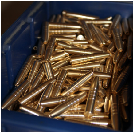
Messingprojektilerne bliver fabrikeret på en højt teknologisk CNC-maskine.
